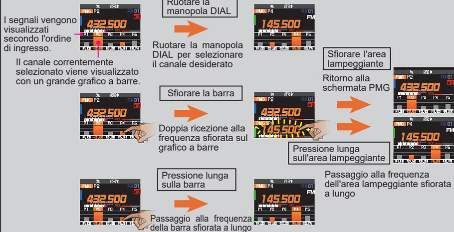
Tenere premuta la manopola **DIAL** mentre si usa la funzione PMG per accedere alla modalità automatica PMG. La modalità automatica PMG avvia automaticamente la doppia ricezione alla ricezione di un nuovo segnale su un altro canale mentre è in corso la ricezione sul canale operativo corrente. Nella modalità automatica PMG, si ascolta automaticamente il nuovo segnale che compare su un altro canale in doppia ricezione continuando a ricevere il canale operativo corrente, senza guardare lo schermo.
