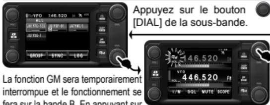
Appuyez sur le bouton [DIAL] de la sous-bande. La fonction GM sera temporairement interrompue et le fonctionnement se fera sur la bande B. En appuyant sur le bouton [DIAL] de la bande A après le fonctionnement de la sous-bande, la fonction GM reprendra.
