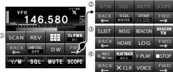
Ces touches peuvent être remplacées par les quatre touches de fonctionnement normalement affichées dans la partie inférieure de l'écran de fréquence (voir le manuel d'utilisation pour plus de détails).
