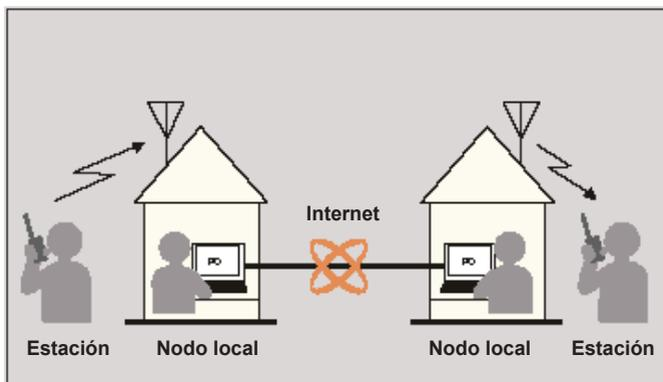
Además de las características propias de WIRES, WIRES-X es compatible también con las comunicaciones digitales. Mediante el uso de WIRES-X, podrá transmitir y recibir datos digitalizados como texto, datos de imágenes y audio.
