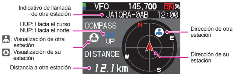
2. Pulse la tecla **[DISP]** para volver a la pantalla de funcionamiento normal.
