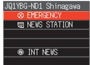
3. Pulse el interruptor **PTT**, sonará un pitido y aparecerá una pantalla de confirmación "EMERGENCY Upload?". Al enviar la información de emergencia, pulse y mantenga pulsado el interruptor **PTT**, después de tres pitidos, la pantalla cambiará a "UPLOAD" y se iniciará la transmisión. Mientras mantiene pulsado el interruptor **PTT**, hable al micrófono.
