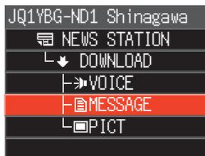
6. Ruotare la manopola **DIAL** per selezionare i messaggio da visualizzare, quindi premere la manopola **DIAL**. I dati vengono scaricati e viene visualizzato il contenuto del messaggio.
