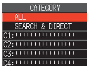
3. Ruotare la manopola **DIAL** per selezionare il nodo o la sala ai quali collegarsi, quindi premere la manopola **DIAL**. Ruotare la manopola **DIAL** per selezionare il nodo o la sala ai quali collegarsi, quindi premere **PTT** per stabilire la connessione.
