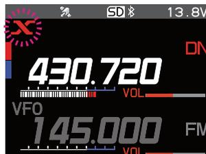
6. Quando viene trovato un nodo locale, la "X" si illumina a luce fissa e sulla parte inferiore dello schermo vengono visualizzati il nome del nodo e quello della città.
