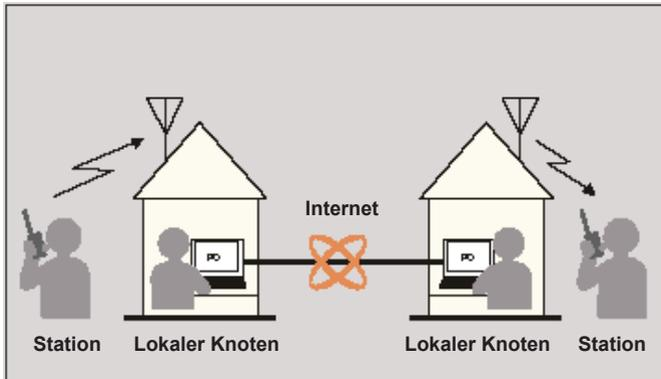
Zusätzlich zur WIRES-Funktion unterstützt WIRES-X ebenfalls digitale Kommunikation. Mithilfe von WIRES-X können Sie digitalisierte Daten wie Text, Bilddaten und Audio senden und empfangen.
