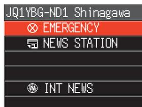
3. Appuyez sur l'interrupteur **PTT**; un bip retentit et un écran de confirmation "EMERGENCY Upload?" s'affiche. Pour transmettre des informations urgentes, appuyez sur l'interrupteur **PTT** et maintenez-le enfoncé; après trois bips, l'affichage de l'écran se change en "UPLOAD" et la transmission commence. Toute en appuyant sur l'interrupteur **PTT**, parlez dans le micro.
