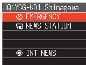
3. Pulse el interruptor **PTT**, sonará un pitido y aparecerá una pantalla de confirmación "EMERGENCY Upload?". Cuando envíe información de emergencia, mantenga pulsado el conmutador **PTT**; después de tres pitidos, la visualización de la pantalla cambiará a "EMERGENCY UPLOADING" durante unos 5 segundos, y luego se iniciará la cuenta atrás. Mientras mantiene pulsado el interruptor **PTT**, hable al micrófono. El tiempo máximo de grabación es un minuto.
