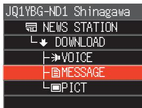
6. Gire el mando **DIAL** para seleccionar el mensaje que desea ver y, a continuación, pulse el mando **DIAL**. Descarga los datos y muestra el contenido del mensaje.
