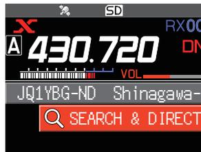
**i** Si la frecuencia del nodo local detectado es diferente de la del canal preajustado, la frecuencia automáticamente cambia a la frecuencia del nodo.
