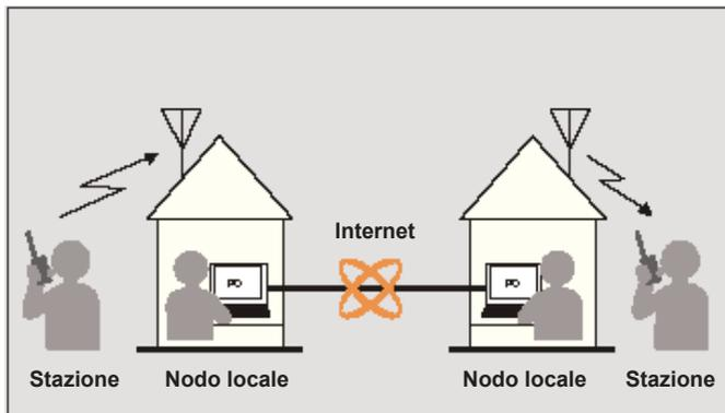
In aggiunta alle funzioni WIRES, WIRES-X supporta anche le comunicazioni digitali. Con WIRES-X, è possibile trasmettere e ricevere dati digitalizzati quali testo, immagini e audio.
