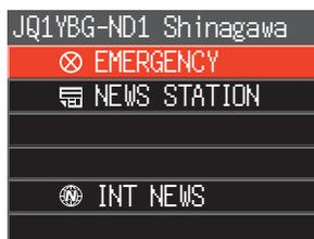
3. Appuyez sur l'interrupteur **PTT**; un bip retentit et un écran de confirmation "EMERGENCY Upload?" s'affiche. Pour envoyer des informations d'urgence, maintenez l'interrupteur **PTT** enfoncé ; après trois bips, l'affichage de l'écran se change en "EMERGENCY UPLOADING" pendant environ 5 secondes, puis le compte à rebours commence. Toute en appuyant sur l'interrupteur **PTT**, parlez dans le micro.
