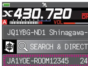
(4) Collegato al nodo locale, collegamento riuscito ad un nodo o sala Internet (il nodo o la sala Internet non sono gli ultimi utilizzati)
