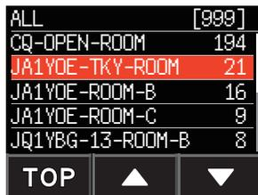
Dopo aver stabilito correttamente il collegamento, vengono visualizzate le opzioni menu del nodo o della sala ai quali si è collegati.
