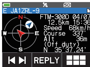
Exemple d'affichage lorsqu'un signal APRS est reçu
