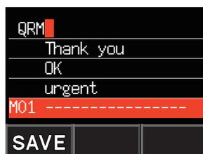
3. Ruotare la manopola **DIAL** per selezionare il numero (da M01 a M10) sul quale registrare il messaggio standard.
