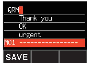
3. Den **DIAL**-Drehregler drehen, um die Nummer (M01 bis M10) auszuwählen, unter der die Standardnachricht registriert werden soll.
