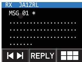
Pulsar **[F MW]** en la pantalla de visualización de frecuencias, seguido de **[M.LIST]** para visualizar la pantalla de APRS MESSAGE LIST.
