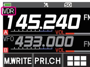
Lorsqu'un signal est reçu sur le canal prioritaire, le bip sonore retentit, et la fonction double réception s'arrête temporairement.
