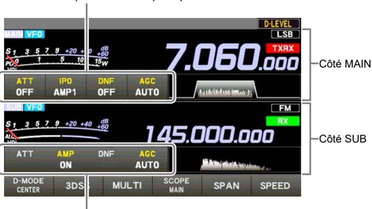
Paramètres importants du récepteur pour le côté SUB
