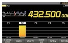
Pendant l'écoute de l'audio reçu sur P2, les canaux P1 et P3 à P5 sont scannés.
