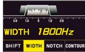
1. Maintenez le bouton [MAIN **DSP**] enfoncé. Tournez le bouton [MAIN **DSP**] pour sélectionner "WIDTH", puis appuyez sur le bouton [MAIN **DSP**]. (La fonction peut aussi être sélectionnée en touchant "WIDTH").
