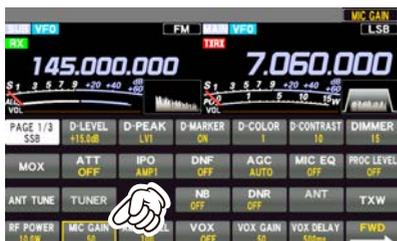
3. Touche TX et tournez le bouton [FUNC] pour régler le niveau d'entrée de l'amplificateur du microphone dans la position où l'aiguille de l'indicateur ALC ne dépasse pas la zone ALC sur les crêtes audio.
