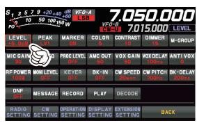
Sulla schermata 3DSS, per facilitare il riconoscimento dei segnali deboli potrebbe essere necessario regolare LEVEL in modo che il livello di rumorosità sia soltanto parzialmente visibile, regolare quindi LEVEL e usarlo sempre nella posizione ottimale.
