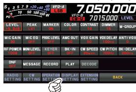
3. Sfiorare [DISPLAY] → [LED DIMMER] o ruotare la manopola [FUNC] per selezionare un'opzione, quindi premere la manopola [FUNC].
