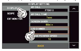
Ruotare la manopola [FUNC], o sfiorare "<" oppure ">" su uno dei due lati del valore per regolare la luminosità.
