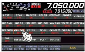
Ruotare la manopola [FUNC] per regolare il livello del monitoraggio.
