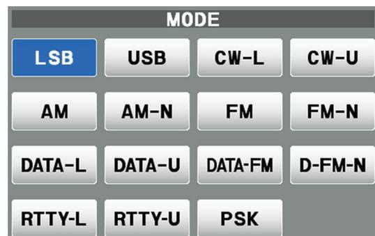
Beim Moduswechsel von SSB auf CW ist auf dem Display eine Frequenzverschiebung zu sehen, obwohl sich der eigentliche Ton, der zu hören ist, nicht ändert.
