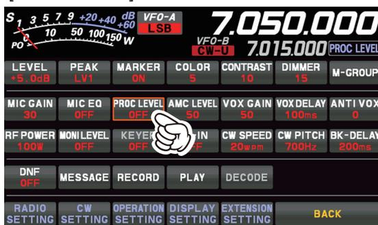
4. Auf dem Display den Meterbereich berühren, um das „COMP“-Meter auszuwählen. Das Sendemeter wird zum „COMP“-Meter.
