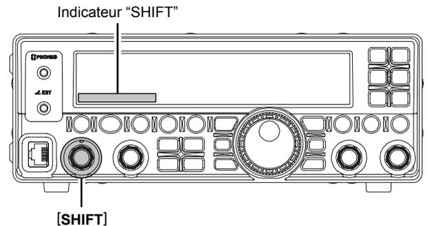
Sur la figure "A", noter que la représentation du filtre DSP FI est une ligne fine, avec le bouton [SHIFT] en position 12 heures. Sur la figure "B", une interférence est apparue à l'intérieur de la bande passante originale. Sur la figure "C", vous pouvez voir l'effet de la rotation du bouton [SHIFT] pour réduire le niveau d'interférence en déplaçant la bande passante du filtre de telle manière que l'interférence soit hors de la bande passante.
