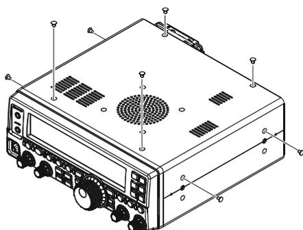
4. Enlever les deux vis de chaque côté et les quatre vis du couvercle inférieur du transceiver et enlever le couvercle inférieur.
