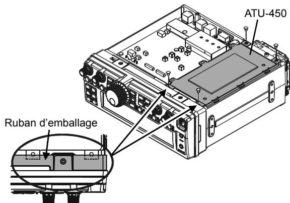
9. Mettre le **FT-450** de façon à accéder au côté supérieur. Brancher la fiche TMP (marquée en vert) allant de l'**ATU-450** au point J5402 sur la platine principale et brancher l'autre fiche TMP (marquée en gris) allant de l'**ATU-450** au point J5404 sur la platine principale. Fixer les deux câbles coaxiaux avec la bride métallique.
