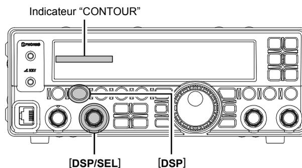
Sur la figure "B", une "indentation" du filtre contour centrée dans la bande passante est présentée. Une rotation du bouton [DSP/SEL] (vers la gauche) fait déplacer l'indentation vers une fréquence plus basse dans la bande passante, tandis qu'une rotation vers la droite du bouton [DSP/SEL] produit l'effet inverse. En enlevant une interférence ou un composant de fréquence sur le signal entrant, il est possible de faire émerger ce signal du bruit de fond et de le rendre plus intelligible.
