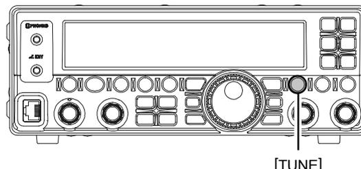
1. Appuyer brièvement sur le bouton **[TUNE]** pour activer le coupleur d'antenne automatique. L'icône "**TUNER**" apparaît sur l'afficheur. Si la fréquence du transceiver est en dehors des bandes amateurs, L'icône "**TUNER**" n'apparaît pas.
