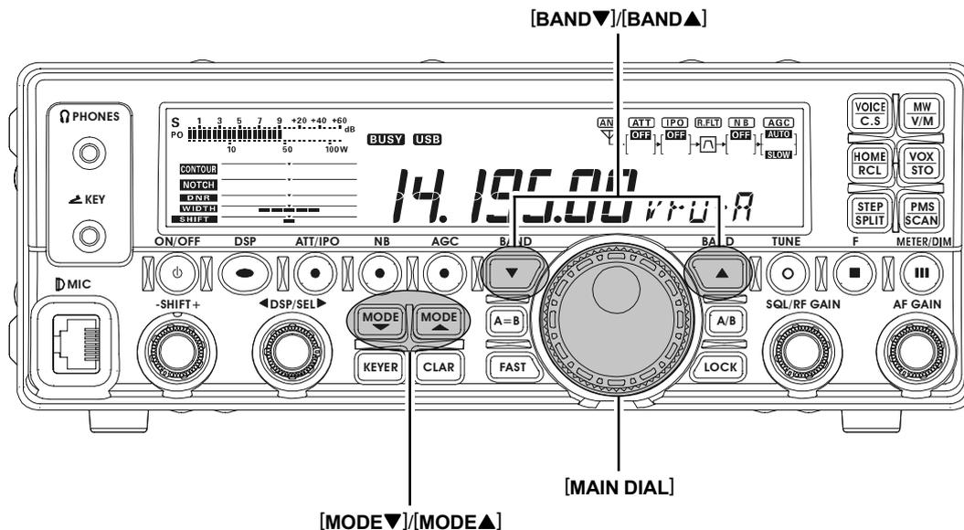
1. Appuyer sur les boutons [BAND▼]/[BAND▲] pour sélectionner la bande opératoire. En appuyant sur les boutons [BAND▼]/[BAND▲], la bande opératoire change comme suit.
