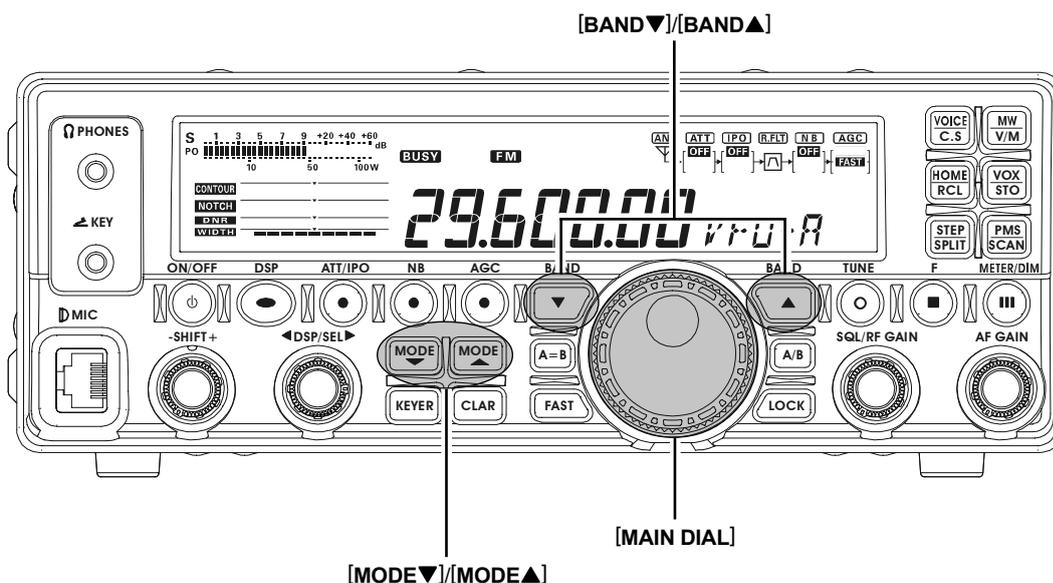
1. Appuyer sur les boutons **[BAND▼]/[BAND▲]** pour sélectionner le 28 MHz ou le 50 MHz.
