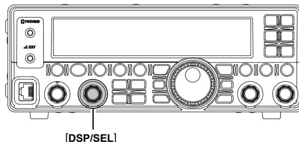
Quand une fonction DSP est engagée, l'icône ">" apparaît à la suite de la fonction sur l'affichage du graphique DSP. Puis en appuyant le bouton [DSP/SEL] la fonction DSP sera commutée sur « on » ou « off ». Quand la fonction DSP est active, le réglage du bouton [DSP/SEL] change les paramètres de la fonction.
