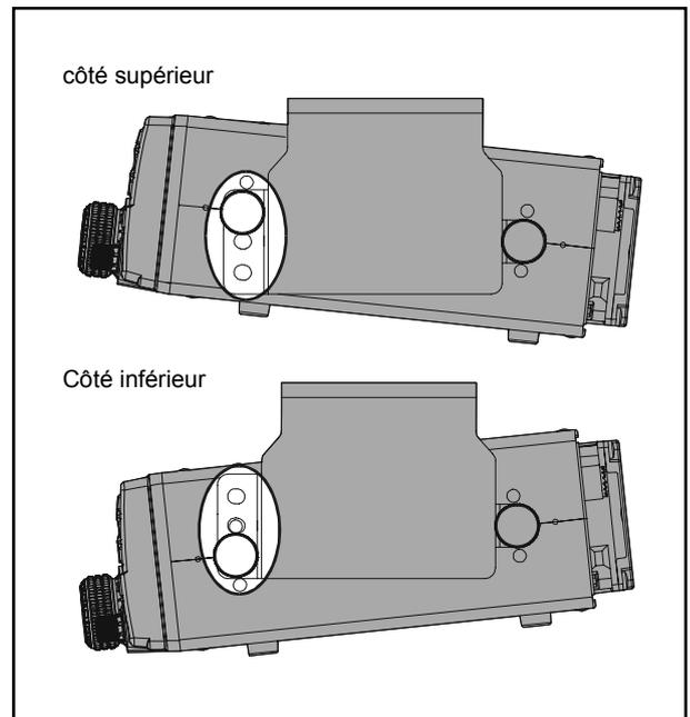
2. Positionner le transceiver dans le support de façon à ce que les trous sur le côté coïncident avec ceux du support. Fixer le transceiver en place utiliser les vis (M4) fournies.
