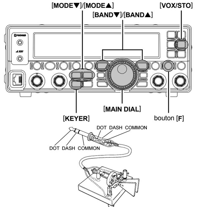
Il est possible de commander la manipulation CW en utilisant les touches [UP]/[DWN] du micro optionnel **MH-31A8J** (quand le manipulateur électronique interne est activé) via la ligne menu "CW PADDLE". Voir page 79 pour plus de détails.
