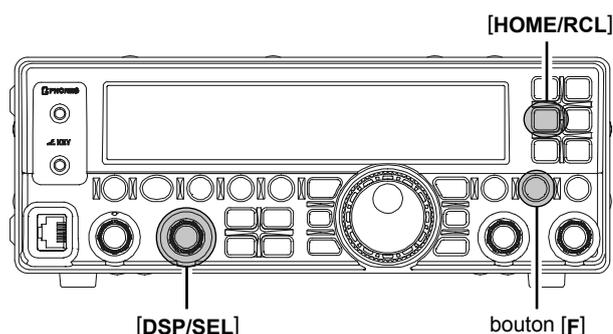
10. Tourner le bouton [DSP/SEL] pour mettre le paramètre à "REV" (défaut: "NOR"). Vous pouvez appuyer sur le bouton [HOME/RCL] pour remettre la configuration des palettes à sa valeur par défaut usine.
