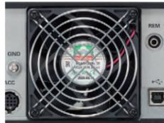
Ventilateur de refroidissement à faible bruit ø80 mm
