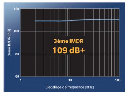
Plage dynamique d'intermodulation de 3ème bande 14MHz (IMDR)
