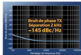
Bruit de phase TX (bande 14 MHz, TX : 100 W, mode : CW)
