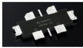
Transistor MOSFET en silicium à faible distorsion
