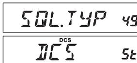
2. Tras oprimir la tecla [**MHz(SET)**] en esta etapa, desplace la perilla de **SINTONÍA** hasta que se ilumine el ícono “DCS” en la pantalla; dicha acción activa la función del Codificador/Decodificador Mediante Código Digital en el radio.
